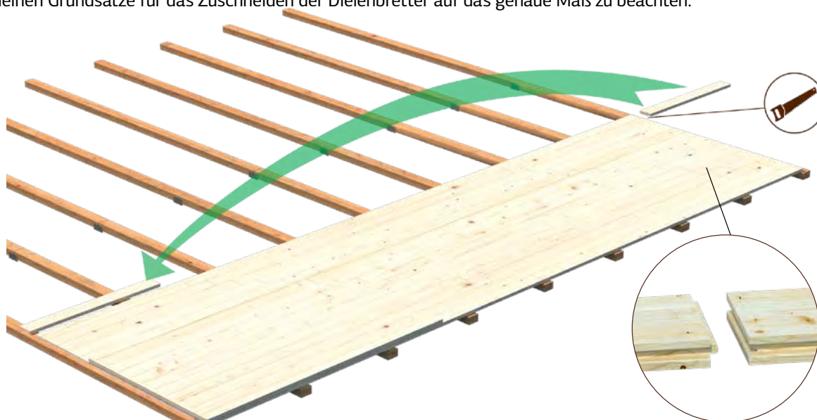
Nut- und Federverbindungen an den Stirnseiten der Dielen
