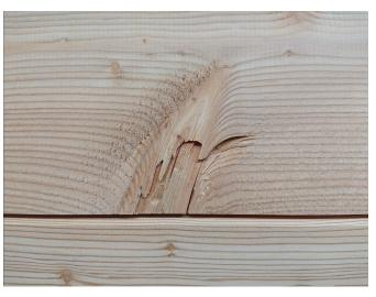
Auch krumme und verdrehte Bohlen müssen akzeptiert werden, insofern diese bei der abgedachten Variante bei seitlicher Fixierung bei den Pfosten ineinander gestülpt werden können. Fehlt eine seitliche Fixierung, so muss mit einem Schwund der Hölzer von 8-10% gerechnet werden. Innerhalb kurzer Zeit fängt durch Sonneneinstrahlung und Witterung die Vergrauung der Hölzer an. Je nach Standort und Holzstruktur kann die Farbe von Schwarz bis Silbergrau variieren.
