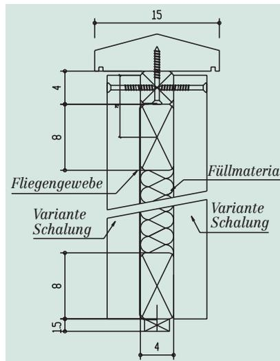
Aussenseite der Lärmschutzwand (schallabsorbierend) – Ausführung Typ 28/34 – links mit Staketen (vierkant), rechts mit Halbrundhölzern:
